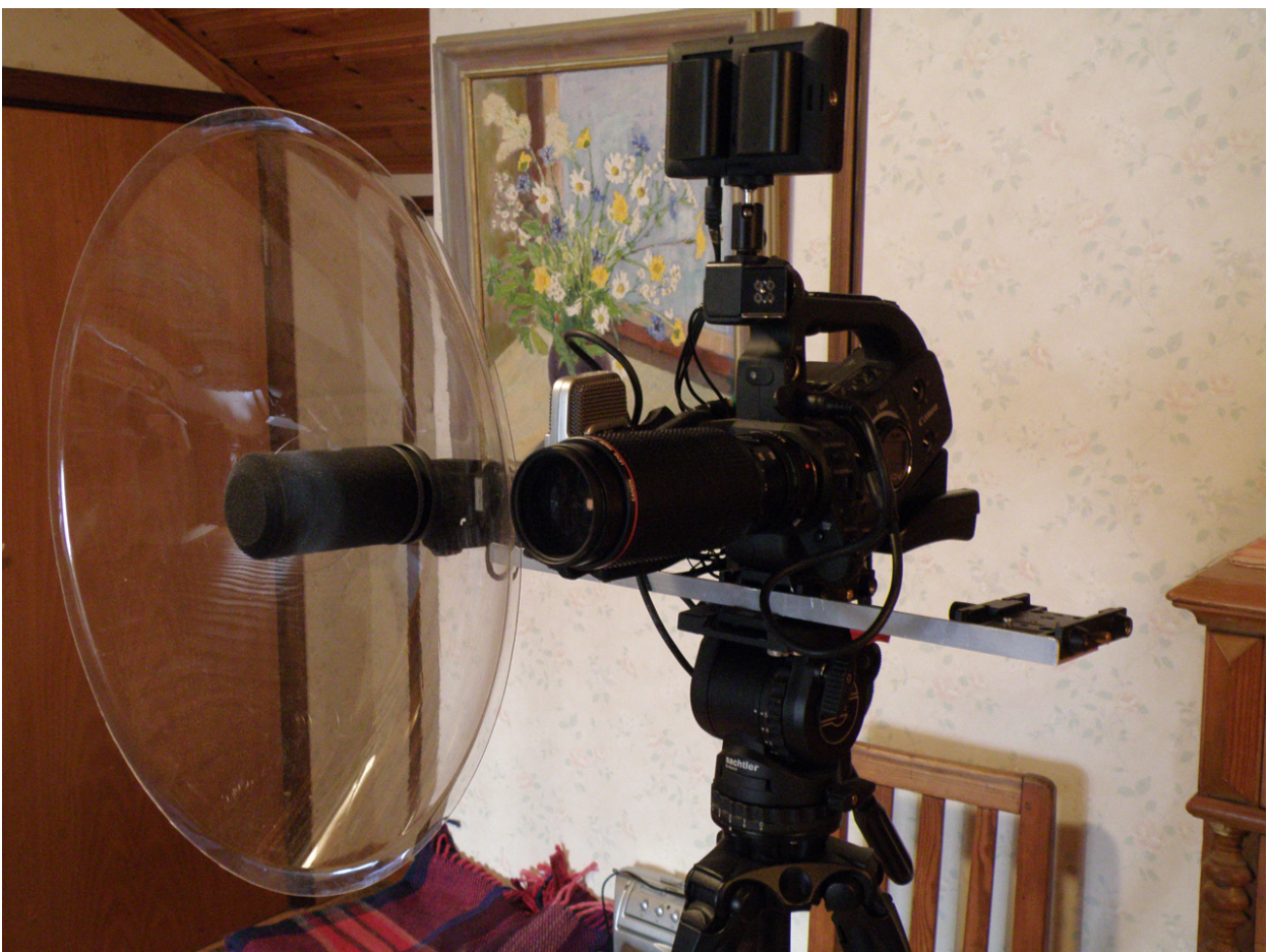
Stativ med Canon XL-H1A, Smallhd 4" monitor, Canon FD 100-300 mm med XL-adaptör (effektiv brännvid 720–2200 mm), Telinga LS-xx med stereo DAT mikrofon, samt Zoom H2
